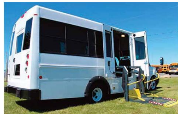
Figure 12. Le Girardin G5 et sa plateforme élévatrice. Source : Girardin-Blue Bird, 2017.
